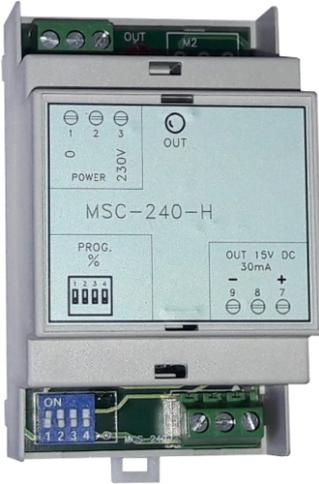
Questo modulo viene utilizzato per generare dei tempi proporzionali SSR fissi. L'uscita logica è adatta a comandare relè statici zero-crossing per ottenere una % media di potenza. I tempi sono programmabili tramite dip-switch con una risoluzione di 1 decimo. Quando alimentato attiva direttamente l'uscita con un tempo di ciclo di 10 sec.
